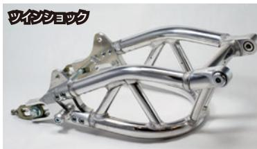
ピボット部分はボールペアリングを標準装備。ピボット部のカラーはペアリングに圧入しカラーが脱落しない設計になっています。チェーン引きは専用設計でメインパイプとの連結部分はボルト(SCM435)での連結になっています。後ろ引きのチェーン引きを標準装備することによりチェーン調整が容易に行えます。スタンドフックが標準装備になっておりメンテナンススタンドが使用できます。
