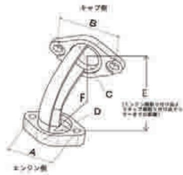
Eはエンジン側取付面の穴センターから、キャブ取付面の穴センターまでの直線距離になります。
