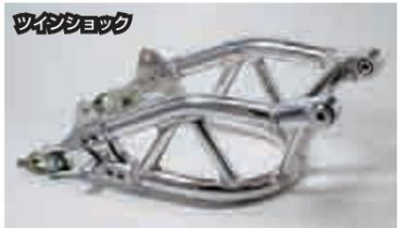
ピボット部分はボールベアリングを標準装備。ピボット部のカラーはベアリングに圧入しカラーが脱落しない設計になっています。
