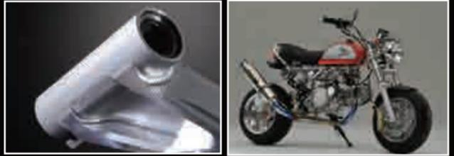
ヘッドパイプ一体削り等、フレーム部品は溶接なしの全てボルトでの組み立て式になっており、エンジンマウントやスイングアームビボットプレート部は、全てネジ部分にノックピン加工を施し、せん断方向の加重をボルトで受けにくい構造にして高強度を実現。オフセット55mmのステムキットを使用せずに、12インチホイール装着時のエンジンヘッドとタイヤとのクリアランスを確保 ※39982の場合は、55mmオフセットステムキットをご使用ください。 エンジン本体が7mmオフセットしているのでオフセットスプロケットを使わずに10インチ4.0Jホイール、NSRホイール装着可能。 純正タンク、純正シート、ツインショック、モノショック(当社モノショック用スイングアーム)が装着可能。ハンドルロック使用可能。
