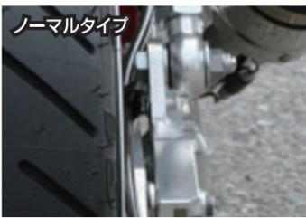
スーパーワイドスイングアームには、リアショック取付方法が内側に固定するタイプと外側に固定するタイプの2種類存在します。
