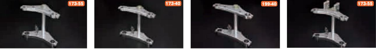
[31192] φ30フォーク用ステムキット JAN.4522285311924 ¥18,500(税抜) A2017材 シルバーアルマイト仕上げ(モンキー、ゴリラ用) フォークピッチ173mm、オフセット55mm ハンドルロック使用可。●ノーマルハンドル専用 ●メーターステー-取付ピッチ59mm、フェンダー-取付ピッチ46mm ●ノーマルハブ装着可能(要ドラムサポート・品番33114) ※ドラム仕様はハブ加工が必要です(ハブ加工・品番33601)
