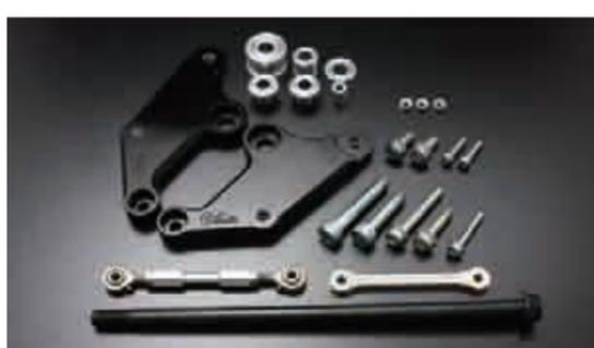
純正ステップを使用し、ポジションを純正より50mmバック、40mmアップさせるステップ移設キットです。チェンジロッドにピロボールを採用し、チェンジペダルの調節が可能になります。純正のブレーキホース使用可能。付属リザーブタンクステーを使用し、移設することで整備性が向上します。(純正リザーブタンク位置はカウルの中)
