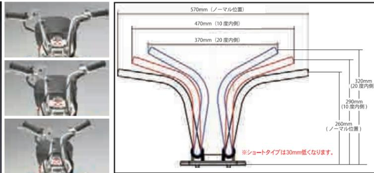
ハンドル取り付け部分の血ポルトを入れ替えることで、ノーマル状態のハンドル幅から内側に10度、20度と3段階変化させることが出来ます。
