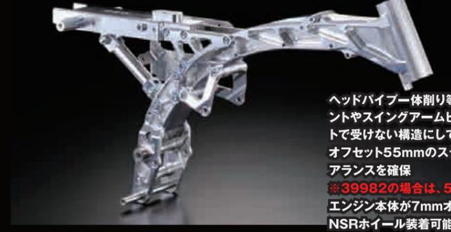
ヘッドパイプ一体削り等、フレーム部品は溶接なしの全てボルトでの組み立て式になっており、エンジンマウントやスイングアームビボットプレート部は、全てネジ部分にノックピン加工を施し、せん断方向の加重をボルトで受けにくい構造にして高強度を実現。オフセット55mmのステムキットを使用せずに、12インチホイール装着時のエンジンヘッドとタイヤとのクリアランスを確保
