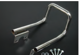
商品名 SLモンキー用Z501Mテールクラブバーステンレス製 税込価格 4,800 円 商品説明 Z501リアキャリア(純正品)を取外し右記の製品とセットで取付けることで、4レタイプテールやウインカーが取り付けできる 商品ID NO1520
