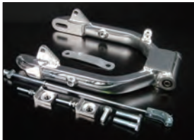
商品名 ダックスポリッシュアルミ製ノーマル長スイングアーム 税込価格 6,900 円 商品説明 スリット加工、アルミ製ノーマル長リアスイングアーム、チェーンリンク、パイプサイズ140mm×102mm、取付けボルト、ナット、ワッシャー、スペーサー、最大重量350kg 商品ID NO2175
