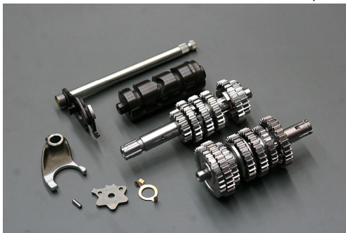
6速スーパークロスミッションキット SUZUKAスペシャル AP-EXμ仕様
