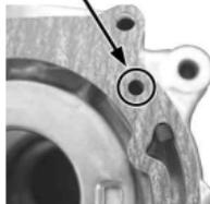
R クランクケースにあるオイルラインにセパレーターを写真の位置に広い方を下側にして取り付けます。
