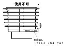
シリンダー左側面に打刻無し、12200 KN4 T00の打刻のシリンダーを使用する場合、シリン ダーとピストンのクリアランスを規定値内に合わせる必要があります。
