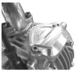
Oリングを L .シリンダーヘッドカバーに取 l り付け、 ソケットキャップスクリュー5× | カバーに取り付け、 ソケットキャップスク 10、 ソケットキャップスクリュー5×15 | リュー4×12でシリンダーヘッドに取り付 でシリンダーヘッドに取り付けます。
