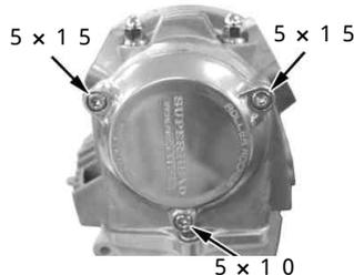
キット内のインスペクションキャップOリングに少量のエンジンオイルを塗布し、インスペクションキャップに取り付け、インスペクションキャップをキット内のキャップスクリュー5×12を用いて取り付け、規定トルクまで締め付けます。
