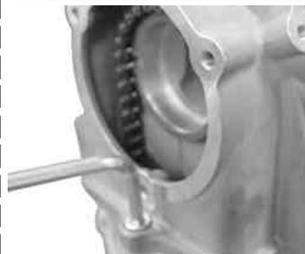
シリンダーのカムチェーンガイドローラーピンを規定トルクまで締め付けます。
