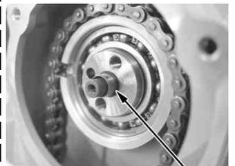
キット内のカムシャフトサークリップを取り付け、カムシャフトを止めます。この時、シリンダーヘッドカム穴の切り欠き部を避ける様に、サークリップの合い口を合わせます。
