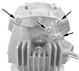
キット内の左サイドカバーOリングに少量のエンジンオイルを塗布し、左サイドカバーに取り付け、キット内のキャップスクリュー5×15 2本と5×10 1本を用いて、シリンダーヘッドに取り付け規定トルクまで締め付けます。(ネジ位置に注意)
