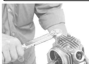
シリンダー部のサイドボルト及びシリンダーヘッド部のサイドボルトを規定トルクまで締め付けます。
