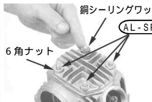
スタットボルトのナットを対角に2～3回に分けて規定トルクまで締め付けます。
