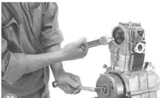
カムチェーン調整を行います。8mmナットを緩め、アジャストボルトAを緩めれば、スプリングにより自動調整されますが、カムチェーンの張りが十分でない場合はアジャストボルトAを緩めたままアジャストボルトBを徐々に締め込み、フライホイールを回しても、カムスプロケットとのガタが無い程度に調整を行います。
