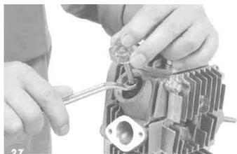
左シリンダーヘッドカバーにキット内の新品ガasketを取り付け、シリンダーヘッド出っ張り部と左シリンダーヘッドカバーの合わせ位置を合わせて取り付け、右シリンダーヘッドカバー部からオリジナルのシーリングワッシャ、フランジボルトを用いて取り付けます。
