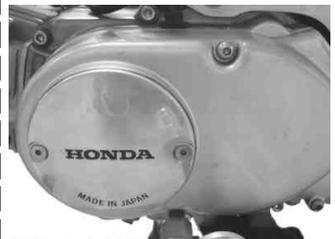
エンジンオイルを使用するクラッチキットの指示している量まで入れます。サービスマニュアルを参照し、ドライブチェーンを取り付けます。
