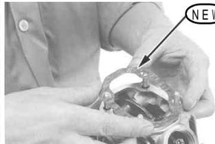
シリンダーヘッドカバーのマークをEXにセットし、スタットボルトネジ部に少量のアルミスペシャルを塗布し、シーリングワッシャとナットを取り付けます。
