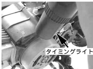
タイミングライト(00-01-009)を用いて、アイドルリング時にフライホイールの'F'マークとクランクケースの合わせマークとが合っているか確認する。
