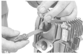
アジャストナットを規定トルクまで締め付けます。
