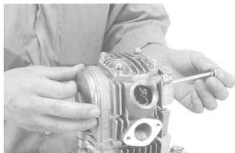
取り付けしたフランジボルトを規定トルクまで締め付けます。
