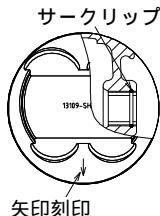
サークリップは必ず上記図の方向に取り付けて下さい。ピストンピンサークリップの合い口は、ピストンピン穴の切り欠き部を避け、ピストンに対して上下方向に合わせます。
