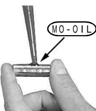
ピストンの矢印がある方をエキゾーストに向け、コネクティングロッドにピストンを取り付けます。ピンが入りにくい場合は、たたき込んだりせず、サインペン等を使用し、ゆっくり差し込んで下さい。
