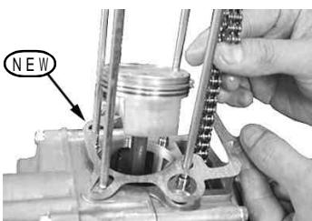
ピストンリングの合い口がずれない様、ピストンリングを圧縮しながらシリンダーを取り付けます。
