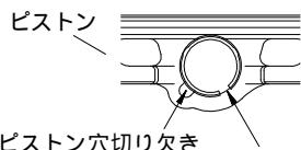
ピストンリング部及びピストンピン部をエアブローし、異物の噛み込みが無い事を確認します。ピストンリング溝にオイルを塗布し、図を参考にしてピストンリングを取り付け、合い口を合わせます。
