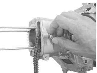
シリンダーサイド部のクランクケースと結合するオリジナルの6角ボルトを仮締めします。シリンダーヘッドを取扱説明書に従い取り付けます。
