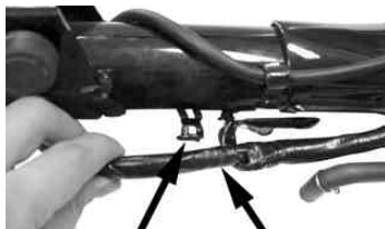
クランプ ワイヤーハーネス ワイヤーハーネスをフレームの下側になるように移動させる。
