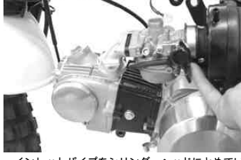
インレットパイプをシリンダーヘッドにとめているボルト2本を取り外しインレットパイプ、キャブレター、エアクリーナーを取り外す。 使用工具 オフセットレンチ 8mm
