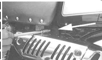
マフラー本体を止めている6角ボルトを反時計方向に回し取り外す。
