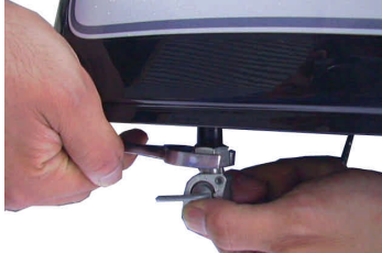
フューエルコックをフューエルタンクから取り外し、キットの物を取り付ける。 使用工具 スパナレンチ 19mm
