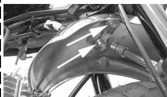
フロントフェンダー裏側の6角ボルト2本を反時計方向に回し取り外す。
