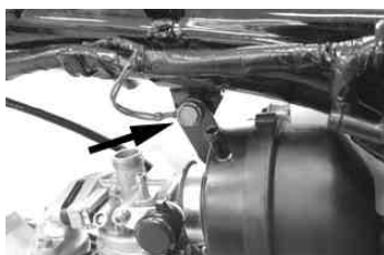
エアクリーナーステー部のボルトを取り外す。 使用工具 ボックスレンチ 10mm エクステンションバー 小
