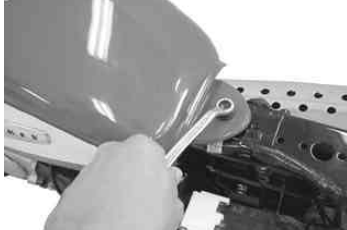
フューエルタンクをフレームにとめているボルトを取り外す。 使用工具 オフセットレンチ 10mm
