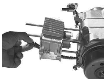
リングがシリンダーにはいったらカムチェーンをシリンダーに通しシリンダーをクランクケースにはめる。
