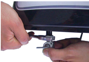
フューエルコックをフューエルタンクから取り外し、キットの物を取り付ける。
