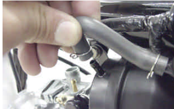
ストレージタンクのホース(フレームNo AB 27-の車両の場合)を抜き取る。
