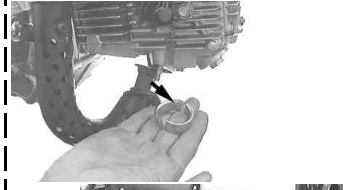
フランジのカラー2個を取り外し外側に引く様にしてマフラーを車体から取り外す。
