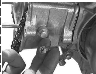
シリンダーサイドボルトを取り付ける。(指でしめる程度まで仮止め)
