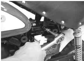
シート下のナットをゆるめ、ボルトを取り外す。
