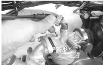
キャブレターのトップキャップを外し、スロットルバルブをキャブレターから抜き取る。
