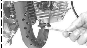
EXパイプ部のナット2個を反時計方向に回し取り外す。
