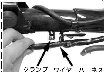
ワイヤーハーネスをフレームの下側になるように移動させる。
