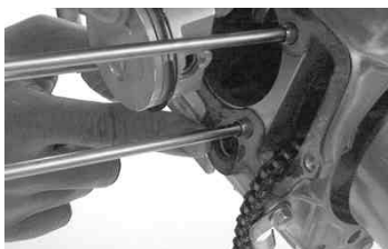
◇シリンダーガスケットとラバーパッキンを取り付ける。
