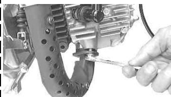
EXパイプ部のナット2個を反時計方向に回し取り外す。
