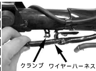
ワイヤーハーネスをフレームの下側になるように移動させる。
