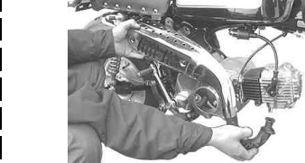
アース線をエアクリーナーステー部のボルトでフレームに取り付ける。
