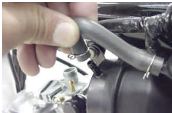
ストレージタンクのホース(フレームNo AB 27-の車両の場合)を抜き取る。
