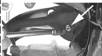
マフラー本体裏側に止まっているナットを反時計方向に回し取り外す。
