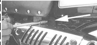
マフラー本体を止めている六角ボルトを反時計方向に回し取り外す。
