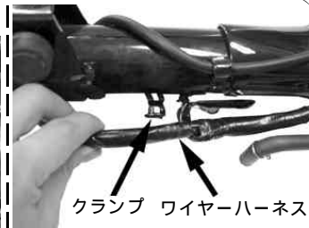
ワイヤハーネスをフレームの下側になるように移動させる。
