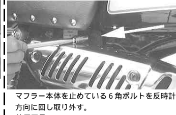
マフラー本体を止めている六角ボルトを反時計方向に回し取り外す。
