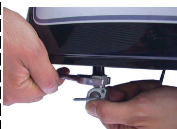
フューエルコックをフューエルタンクから取り外し、キットの物を取り付ける。
