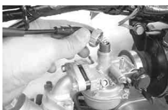
キャブレターのトップキャップを外し、スロットルバルブをキャブレターから抜き取る。
