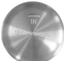
“IN”文字が上（インテーク側）になるようにピストンを取り付ける。
