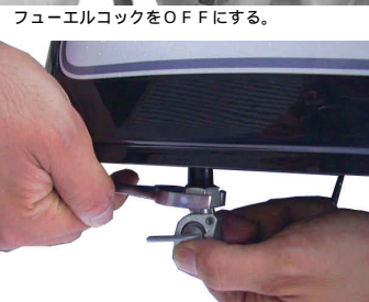
フューエルコックをフューエルタンクから取り外し、キットの物を取り付ける。
