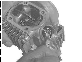
シリンダーヘッドに組まれているロッカーアームのタブナットとボルトを取り外す。タブナットを緩めた時点でタブボルトをナットと一緒に取り外す。
