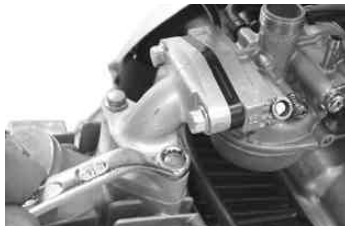
マフラー本体を止めている六角ボルトを反時計方向に回し取り外す。
