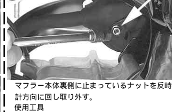
マフラー本体裏側に止まっているナットを反時計方向に回し取り外す。
