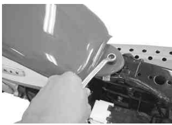
フューエルタンクをフレームに止めているボルトを取り外す。 使用工具 オフセットレンチ 10mm
