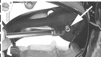
マフラー本体裏側に止まっているナットを反時計方向に回し取り外す。
