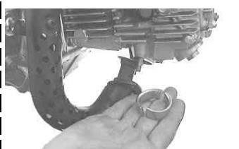
フランジのカラー2個を取り外し外側に引く様にしてマフラーを車体から取り外す。
