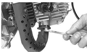
EXパイプ部のナット2個を反時計方向に回し取り外す。 使用工具 スパナレンチ 10mm
