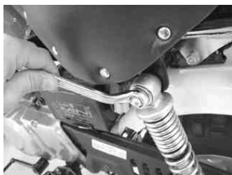
リアショックのナット2個を緩める。 使用工具 オフセットレンチ 14 mm
