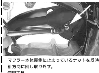
マフラー本体を止めている6角ボルトを反時計方向に回し取り外す。 使用工具 ボックスレンチ 12 mm エクステンションバー 中
