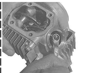
シリンダーヘッドに組まれているロッカーアームのタペットナットとボルトを取り外す。タペットナットを緩めた時点でタペットボルトをナットと一緒に取り外す。
