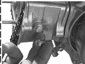
シリンダーサイドボルトを取り付ける。(指でしめる程度まで仮止め)
