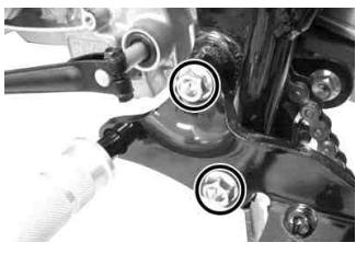
まず、上側のボルトを抜き取り、カラー(A p eの場合)とクラッチケーブルガイドを取り外します。
