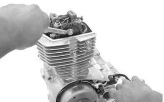
ロックボルトとセットプレートを取り外し、アジャスターを取り外します。
