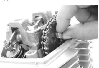
カムシャフトホルダーナット4個を対角に数回に分けて緩めてワッシャ4個、カムシャフトホルダー、カムシャフト、ブッシュ(A p e, F I )ノックピンを取り外します。
