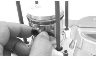
付属のピストンピンサークリップを取り付けます。
