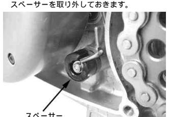
ドライブスプロケットの2本のボルトを外し、
