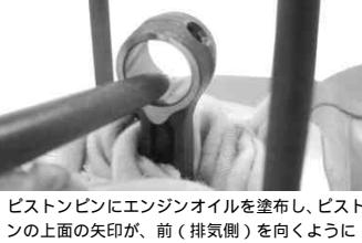
ピストンピンにエンジンオイルを塗布し、ピストンの上面の矢印が、前(排気側)を向くようにピストンを取り付けます。
