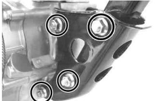
シリンドーヘッド、シリンドー、ピストンの取り外し
