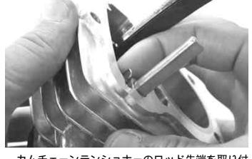
カムチェーンテンションナーのロッド先端を取り付け面と同じぐらいの位置にします。
