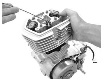
ロックピン2個は、再使用するので取り外しておきます。
