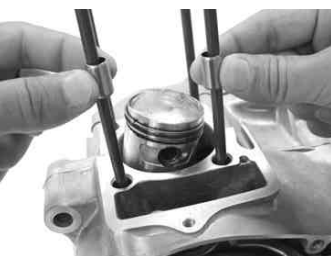
ロックナットとアジャストボルトをシリンダーから取り外します。
