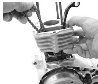
ロックピン2個は、再使用するので取り外しておきます。
