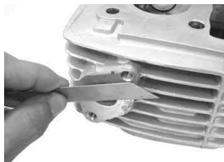
シリンダーヘッドのマニホールド取り付け面のガスケットカスをスクレーパーやカッターナイフ等できれいに取り除きます。
