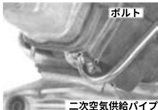
二次空気供給パイプ
