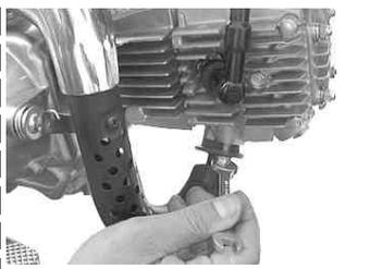
エキゾーストパイプ部のナット2個を締める。(仮止め)
