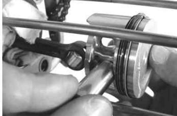
ピストンに三分の一程度ピストンピンを挿しておいて取り付けるのも簡単な方法ではある。
