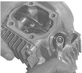
シリンダーヘッドに組み込まれているロッカーアームのアジャストナットとボルトを取り外す。アジャストナットを緩めた時点でタペットボルトをナットと一緒に取り外す。
