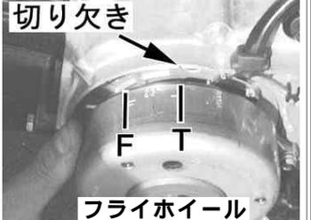
フライホイールのTマークとカムプロケットのOマークが各切り欠きに合う様にフライホイールを反時計方向に回転させて合わせる。
