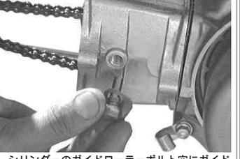
シリンダーのガイドローラーボルト穴にガイドローラーのセンターが合う様に押し込み、シーリングワッシャとガイドローラーボルトを取り付ける。(指で閉まる程度まで仮止め)
