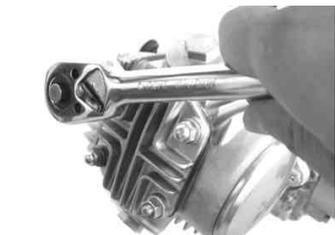
シリンダーヘッドカバーを止めているナット4個を対角の順番に数回に分けて緩めて取り外す。ナット下にあるワッシャ4枚を取り外す。
