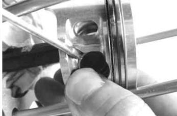
付属のピストンピンサークリップをサークリップ溝にきっちりとはめ込む。この時、サークリップの合い口は切り欠き部を避けて、ピストン上下方向に向けて取り付け。
