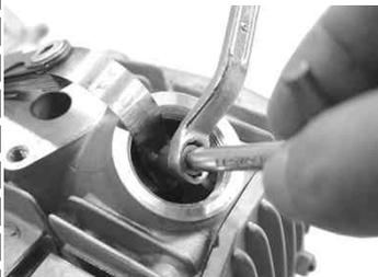
ロッカーアームのアジャストスクリューとバルブステムエンドの間に0.05ミリのシムネスゲージを入れてアジャストスクリューを締め込んでいき、少し抵抗があるくらいでシムネスゲージが引き抜ける様に合わせてアジャストナットを締め付ける(少し抵抗があるというのがわからない場合0.07と0.03のシムネスゲージを用意して0.07がすぎ間に入らず0.03が緩めに入る様に合わせればだいたい0.05ミリということになる)IN・EX共に0.05ミリに合わせる。
