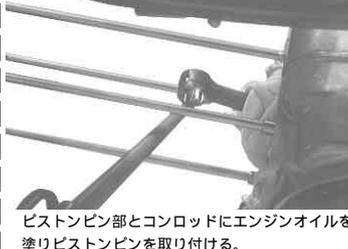
ピストンピン部とコンロッドにエンジンオイルを塗りピストンピンを取り付ける。
