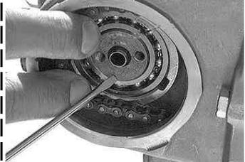
カムプロケットボルト穴をシリンダーヘッドの切り欠き方向に向けたときカム山がピストン側を向く様にカムシャフトをセットする。それがカムシャフトの圧縮上死点です。オプションカム取り付けの場合、オプションカムの説明書の指示に従ってください。
