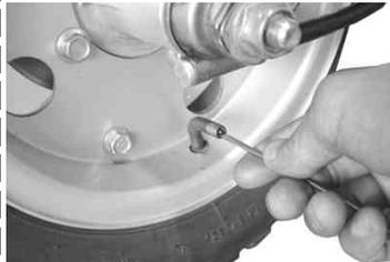
フロントタイヤの空気を抜く。(ドライバーの先等でバルブを押すとエアが抜けるのでシューという音がなくなるまで押し続ける。)
