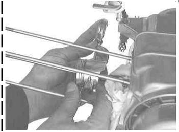
ピストンピンをサークリップが付いていない方向へ取り外す。サークリップが付いている方向からマイナスドライバーで押すと簡単にとれる。
