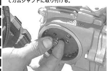
カムプロケットのOマークとシリンダーヘッドの切り欠き部が合う様にカムチェーンをはめてカムシャフトに取り付ける。
