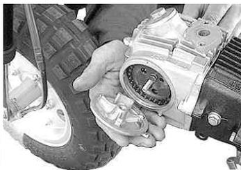
シリンダーヘッド左カバーガスケットと左カバーを取り付ける。
