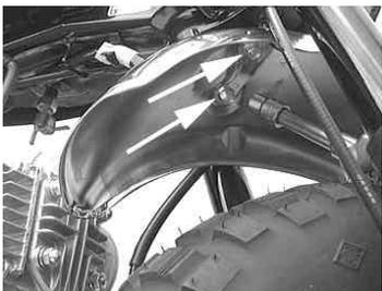
フロントフェンダー裏側の六角ボルト2本を締め付けて取り付ける。
