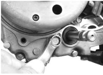
先程、取り外したチェンジベダルシャフト横のボルト穴にエンジンオイルを少量注入し、六角ボルトとシーリングワッシャを取り付ける。
