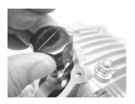
アジャストナットを規定トルクまで締め付けます。 ▲注意:必ず規定トルクを守る事。
