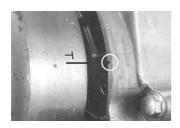
カムシャフトCOMP .のベアリング部にエンジンオイルを差し、シリ ンダーヘッドに取り付け、IN/EXのカム山を燃焼室側にカムシャ フトをセットします。
