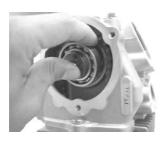
カムシャフトに8×12ノックピンを差し込み、カムシャフトサーク リップを取り付け、カムシャフトを止めます。
