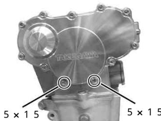
ソケットキャップスクリューをそれぞれ対角に2～3回に分け、規定トルクまで締め付けます。
