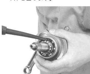
クランクケースにキット内のガスケット、ノックピンをセットし、右クランクケースを取り付けます。
