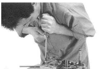
使用するクラッチキットの取り付け要領を守り、クラッチを組み付けます。
