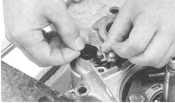
スタッフボルトネジ部に少量のアルミスペシャルを塗布し、クランクケースにスタッフボルトを取り付け、規定トルクで締め付けます。
