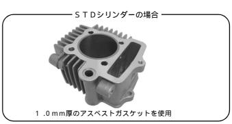
△ 注意:シリンダーヘッドガスケットを間違って使用するとエンジン破損の原因につながる恐れがあります。
