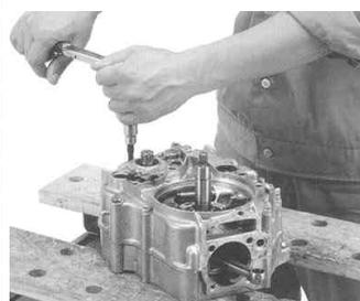
ギヤシフトドラムワッシャの向きに注意し、六角ボルトを用いて規定トルクまで締め付け、ラバープラグを取り付けます。
