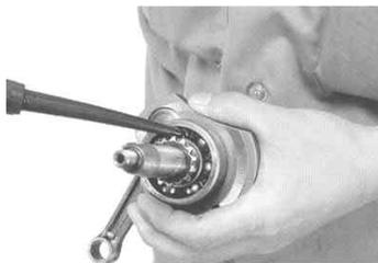
クランクケースにクランクシャフトを取り付け、クランクケースにノックピンをセットします。
