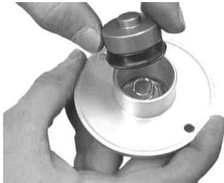
3. ハイドロリッククラッチカバーにガスケットを入れR.クランクケースカバーにしっかりとはめ込みソケットキャップスクリューで仮締めし、指定トルクで締め付けます。
