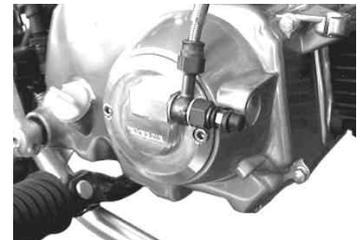
2. トランスミッションがニュートラル状態でエンジンを始動し、各部のオイル漏れを点検します。異常が無ければ安全な場所で低速度の走行テストを行いクラッチの作動を確認して下さい。
