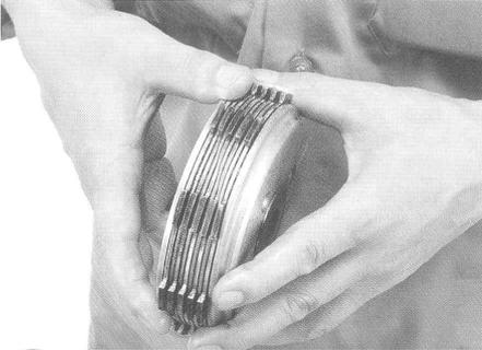
2. クラッチフリクションディスクの突起部をクラッチアウターの溝に合わせ、同時にクラッチセンターのスプラインをメインシャフトアダプターのスプラインに合わせた状態でクラッチASSYを取り付けます。
