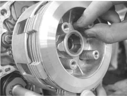
3. 付属のスナップリングの角が丸くなっている方を下側に向け、メインシャフトアダプターの溝部に取り付けます。
