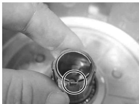
5. ギヤホルダー等を使用し、クランクシャフトの回り止めをした状態でロックナットを指定トルクで締めつけて、ロックワッシャの爪を折り曲げます。
