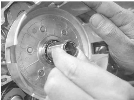
4. ストッパーを時計回りに回転させ、トランスミッションメインシャフトとメインシャフトアダプターを連結させます。ストッパーの凸部がメインシャフトアダプターの切り欠き部にはまる所まで回して下さい。ストッパーの鍵状の部分がトランスミッションメインシャフトの溝部に入り、連結されます。メインシャフトアダプターを引っ張っても外れない事を確認して下さい。
