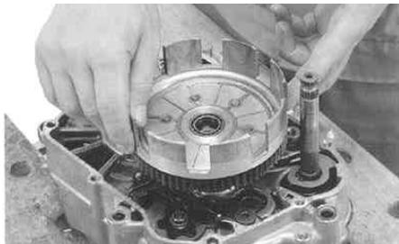
3. ギアホルダー等を使用し、クランクシャフトの回り止めをした状態でロックナットを指定トルクで締め付けて、ロックワッシャの爪を折り曲げます。
