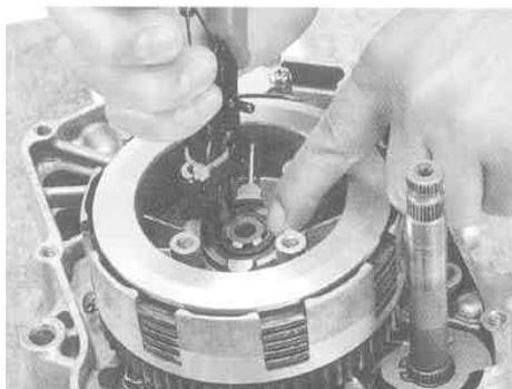
4. プレッシャープレートボス部にクラッチスプリング4本を入れ、クラッチリフタープレートをフランジ六角ボルトで取り付け、対角に2～3回に分けて指定トルクで締め付けます。
