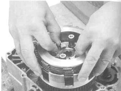
3. 付属のエキスターナルサークリップの角が丸くなっている方を下側に向け、メインシャフトの溝部に取り付けます。サークリップは必要以上に広げないで下さい。サークリップがメインシャフトの溝に取り付けにくい場合は、メインシャフトを引き上げて作業を行なって下さい。
