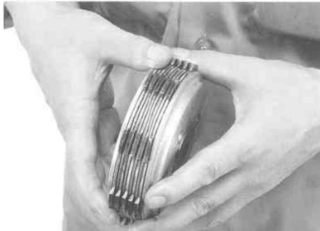
2. トランスミッションメインシャフトにクラッチスペーサーを取り付けます。クラッチフリクションディスクの突起部をクラッチアウターの溝に合せ、同時にクラッチセンターのスプラインをメインシャフトのスプラインに合せた状態でクラッチASSY.を取り付けます。
