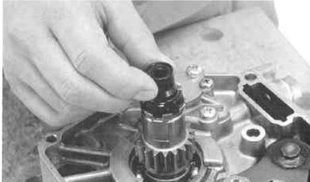
2. トランスミッションメインシャフトに、スラストベアリングシート、スラストベアリング、スラストワッシャ、ワッシャの順に差し込み、クラッチアウターCOMP.を取り付けます。
