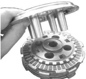
5. クラッチフリクションディスクの突起部をクラッチアウターの溝に合せ、同時にクラッチセンターのスプラインをメインシャフトのスプラインに合せた状態でクラッチASSY.を取り付けます。
