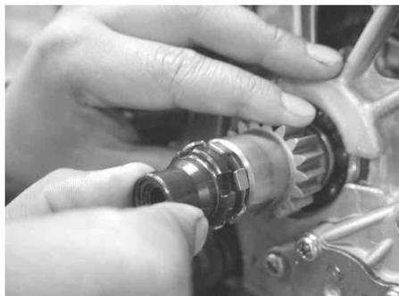
2. メインシャフトアダプターにストッパーを差し込みます。ストッパーの方向に注意して下さい。
