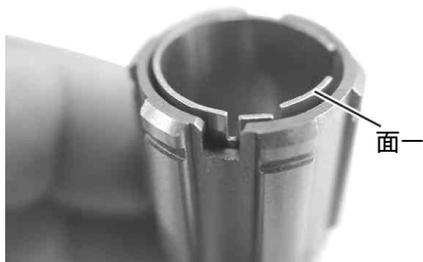
ストッパー上部の凸部がメインシャフトアダプターの切り欠き部の右側にある。
