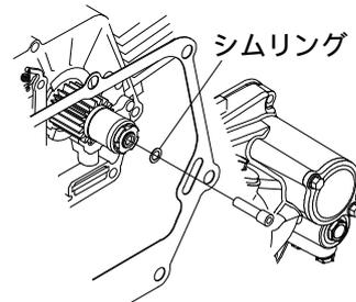
3. フランジボルト8本を対角に数回に分けて指定トルクで締め付けます。
