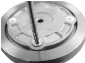
3. ロックナットを取り外し、ワッシャ、オイルフィルターローターを抜き取ります。
