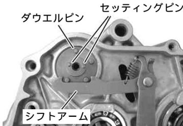
9. シフトドラムサイドプレートの穴をシフトドラムセッティングピンに合わせて取り付けます。
