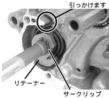
8. シフトドラムにダウエルピン4本とストッパープレートセッティングピン2本を取り付け、加工したギヤシフトアームを取り付けます。シフトスピンドル、ギヤシフトアームの摺動面にエンジンオイルを塗布して下さい。
