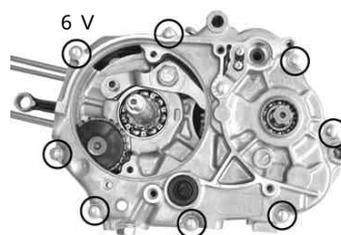
6. シフトドラムサイドワッシャの角が丸くなっている方をシフトドラム側に向け、六角ボルトを規定トルクで締め付けます。
