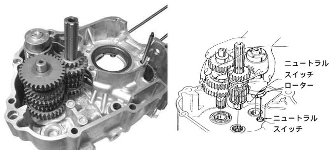
3. キックスタータースピンドルよりワッシャ 17MM、セッティング 20MM、スタータドライブラチェット、セッティング 20MM、スラストワッシャ 20MM スターターピニオンの順に取り外します。キックスタータースピンドルにキット内スターターピニオンを取り付け、逆手順で外した部品を組み付けます。
