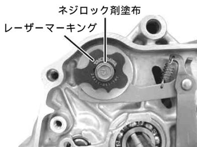
11. ストッパーアームにスプリングをセットし、ストッパープレートに合わせてケースに取り付け、規定トルクで締め付けます。
