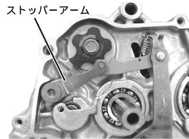
12. メインシャフトを手で回しながら、ストッパープレートのロックボルトをソケットレンチ等で回転させギヤの入り具合を確認します。
