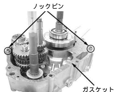
5. Rクランクケースを合わせてLクランクケースが上になるようにします。クランクケースボルトを取り付け対角に2～3回に分けて規定トルクで締め付けます。
