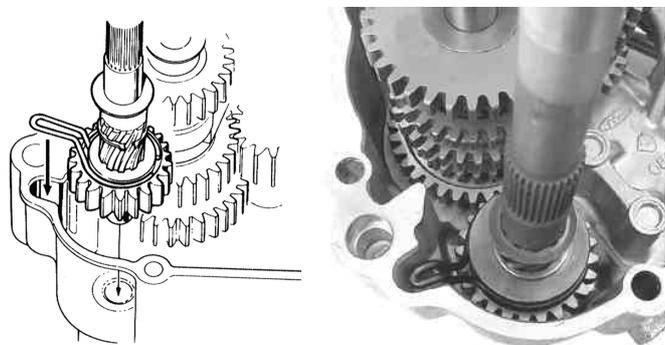
フリクションスプリングをLクランクケースの溝に合わせてスターターースピンドルを取り付けます。
