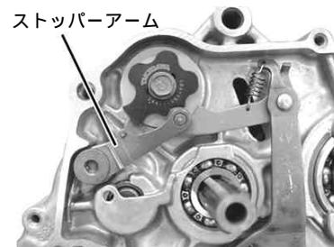
12. メインシャフトを手で回しながら、ストッパープレートのロックボルトをソケットレンチ等で回転させギアの入り具合を確認します。
