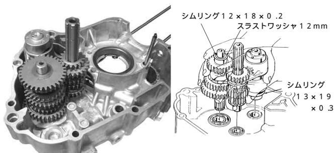
3. キックスターースピンドルよりワッシャ17mm、セットリング20mm、スタードライブラチェット、セットリング20mm、スラストワッシャ20mmスターターピニオンの順に取り外します。キックスターースピンドルにキット内スターターピニオンを取り付け、逆手順で外した部品を組み付けます。
