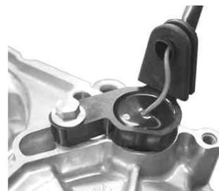
7. R クランクケースを上にし、スタータスピンドルにキックスタータースプリングとキックスプリングリテーナーを取り付け、スプリング端部をケースに引っかけます。エキスターナルサークリップを取り付けます。
