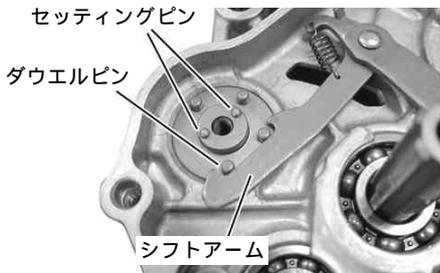
9. シフトドラムサイドプレートの穴をシフトドラムセッティングピンに合わせて取り付けます。
