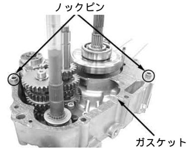
5. R.クランクケースを合わせてL.クランクケースが上になるようにします。クランクケースボルトを取り付け対角に2～3回に分けて規定トルクで締め付けます。
