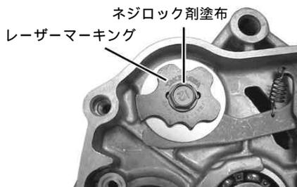
11. ストッパーアームにスプリングをセットし、ストッパープレートに合わせてケースに取り付け、規定トルクで締め付けます。
