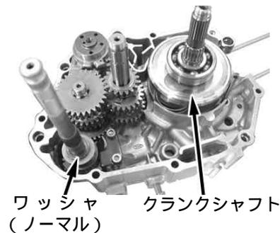
7. 左右クランクケース合わせ面を脱脂し、ロックピンを入れ新品のガスケットを取り付けます。右クランクケースを組み合わせ、ケースガ密着していることを確認します。左クランクケースを上にし、クランクケース、ボルトを入れ中心より外側に対角線上に、指定トルクで締め付けます。
