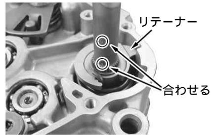
13. ドラムストッパー部分とシフトアームにエンジンオイルを塗布します。メインシャフトを手で回転させ、フラットスクリューにドライバーを掛け、シフトドラムを回して各ギヤの入り具合を確認します。
