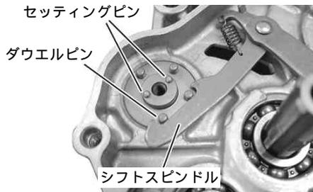
10. シフトドラムサイドプレートの穴をシフトドラムセッティングピンに合わせて取り付けます。
