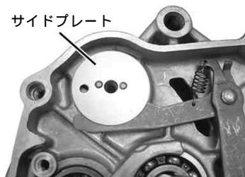
11. シフトドラムにサイドプレートをのせ、ドラムストッパープレートのレーザーマーキング面を上にして取り付けます。ロックボルトにネジロック剤を塗布し、指定トルクで締め付けます。
