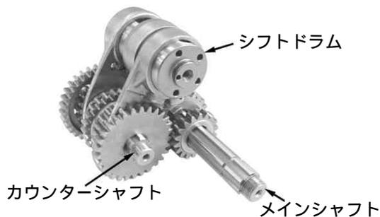
3. シフトドラムを回転させ、ニュートラル位置にします。メインシャフト、カウンターシャフト、シフトドラムを一体で左クランクケースに組み付けます。
