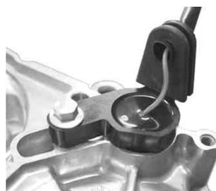
7. R クランクケースを上にし、スタータスピンドルにキックスタータースプリングとキックスプリングリテーナーを取り付け、スプリング端部をケースに引っかけます。エキスターナルサークリップを取り付けます。
