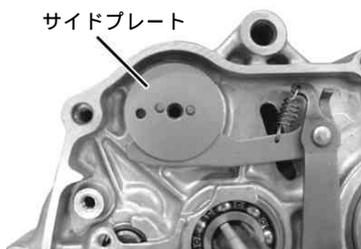
10. シフトドラムストッパープレートのマーキングが見えるようにシフトドラムセッティングピンに取り付けます。ノックボルトのネジ部にネジロック剤を塗布して指定トルクで締め付けます。
