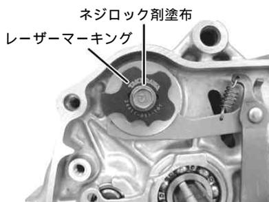
11. ノーマルのストッパーアームにスプリングをセットし、ストッパープレートに合わせてケースに取り付け、規定トルクで締め付けます。
