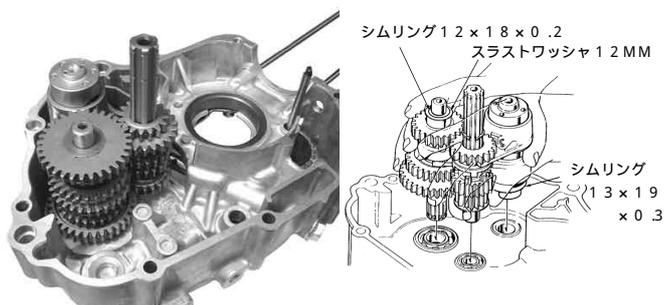
3. キックスタータースピンドルよりワッシャ 17MM、セツリング 20MM、スタードライブブラチェット、セツリング 20MM、スラストワッシャ 20MM スターターピニオン順に取り外します。キックスタータースピンドルにキット内スターターピニオンを取り付け、逆手順で外した部品を組み付けます。
