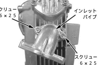
インレットパイプにインシュレーターをソケットキャップスクリュー2本を用いて締付けます。
