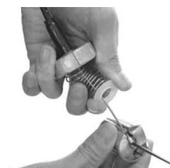
キャブレターをインシュレーターに差し込み、クランプバンドで締め付けます。
