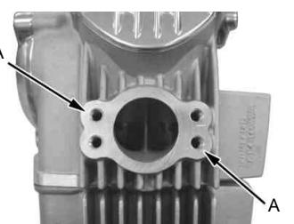
シリンダーヘッドとインレットパイプの間にインレットパイプガスケットを挟み、6×25のソケットキャップスクリューを用いて取り付け締め付けます。
