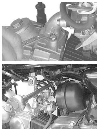
スロットルバルブをキャブレターから取り外し、スロットルバルブとスロットルケーブルを分離し、スロットルケーブルからトップカバーを抜き取ります。
