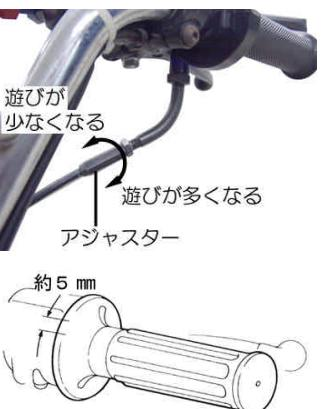
スロットルを数回スナップさせ引っかかりやスロットルバルブの全開状態を確認します。ステアリングを左右いっぱいに切った状態でもスロットルに遊びがあることを確認して下さい。
