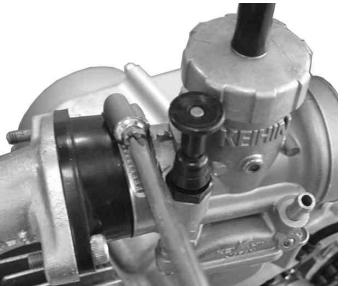
エアフィルターを取り付け、バンドを締め付けて固定します。
