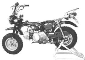
2. フューエルコックが閉じてあることを確認してキャブレターのドレンコックを開きフロートチャンバーからガソリンを受け皿に抜き取ります。
