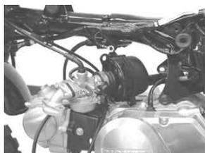
4. スロットルバルブをキャブレターから取り外し、スロットルバルブとスロットルケーブルを分離し、スロットルケーブルからトップカバーを抜き取ります。
