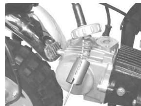
5. スロットルバルブの切り欠き部をスロットルストップスクリューに合わせてキャブレターに取り付けます。
