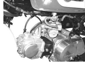
11. チョークレバーを引きエンジンを始動させ各部からの吸気漏れの有無を確認します。チョークレバーを徐々に戻し、回転がスムーズになるまで暖機運転を行いチョークレバーを完全に戻します。エンジン暖気後アイドリングしない場合や、アイドリング回転数が高い場合は、スロットルストップスクリューで調整します。
