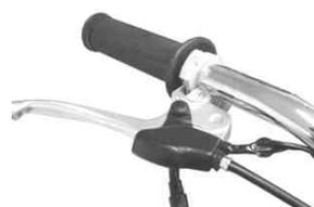
2. スロットル撓動面にグリスを塗布し、スロットルハウジングを取り付けます。パンスクリューを締め付けます。
