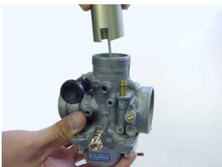
4. キャブレターをインシュレーターに差し込み、クランプバンドで締め付けます。
