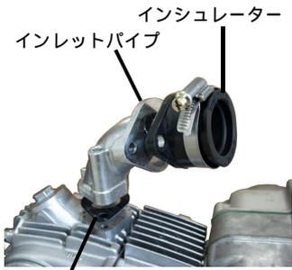
2. インレットパイプにインシュレーターをソケットキャップスクリュー2本を用いて締付けます。**規定トルク = 10 N・m (1.0 kgf・m)**
