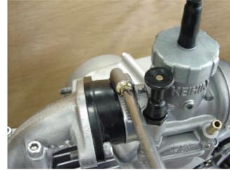
5. スロットルグリップ部で5mm程度の遊びが出来るようにスロットルケーブルのアジャスターを調整します。
