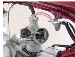
14. チョークレバーを引きエンジンを始動させ各部からの吸気漏れの有無を確認します。チョークレバーを徐々に戻し、回転がスムーズになるまで暖機運転を行いチョークレバーを完全に戻します。エンジン暖気後、アイドル回転しない場合や、アイドル回転数が高い場合は、スロットルストップスクリューで調整します。
