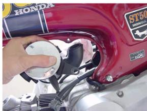
5. スロットルハウジングのパンスクリューを外し、スロットルケーブルを抜き取ります。スロットルハウジング、パンスクリューは再利用しますのでご注意ください。
