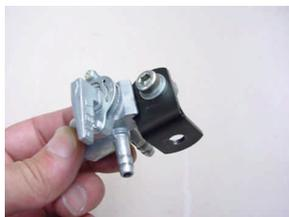
エアークリーナーマウントボルトが取り付けであったネジ穴にカラーを差し込み、フューエルコックステーをソケットキャップスクリューM6×15mmとワッシャ6mmで取り付けます。規定トルク = 10N・m(1.0kgf・m)
