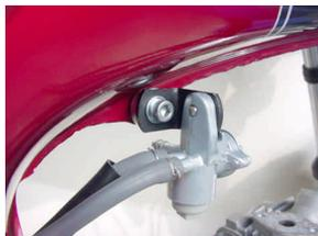
3. アンダースロットルハウジングにスロットルケーブルを仮締めしインナーケーブルをスロットルパイプに取り付けます。
