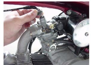
エアークリーナーマウントボルト、インレットパイプマウントボルトを外し、インレットパイプごとキャブレターを取り外します。
