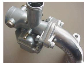
9. 付属のスロットルケーブルを無理が掛からないようにキャブレターまで取り回します。スロットルケーブルにキャブレタートップを取り付け、スロットルバルブスプリングを圧縮した状態でインナーケーブルをスロットルバルブに取り付けます。
