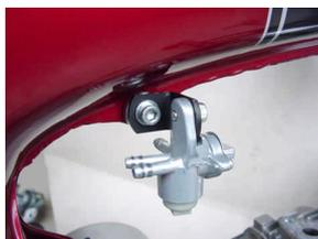
2. ガソリン漏れに注意してフューエルチューブをつなぎ変えます。フューエルチューブに縦の筋が入っている方がRES側です。チューブに老化、ヒビ割れがある場合は、チューブを交換して下さい。
