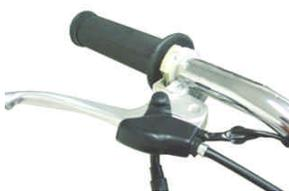
4. スロットル摺動面にグリースを塗布し、スロットルハウジングを取り付けます。パンスクリューを締め付けます。規定トルク = 8N・m(0.8kgf・m)
