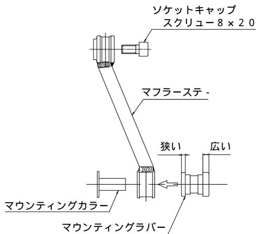
エキゾーストパイプにマフラーパイプを差し込みます。マフラーパイプのステ-部とフレームとを結合はせずに、サイレンサー部をサイレンサーバンド、ソケットキャップスクリュー、ブレンワッシャ、フランジナットを用いて取付けます。
