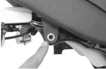
KIT内のマフラーステ-をシートステ-部にソケットキャップスクリューを用いて取り付け仮締めし、マフラーステ-のカラー部にマウンティングラバー、マウンティングカラーを図の様に取付けます。
