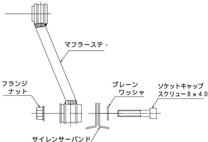
シリンダーヘッドEXポート部のフランジナットを均等に規定トルクまで締め付けた後、サイレンサーステ-部のソケットキャップスクリューを規定トルクまで締め付けます。
