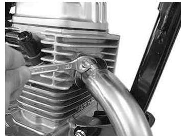
$T = 10 \sim 12 \text{ N} \cdot \text{m} (1.0 \sim 1.2 \text{ kgf} \cdot \text{m})$
