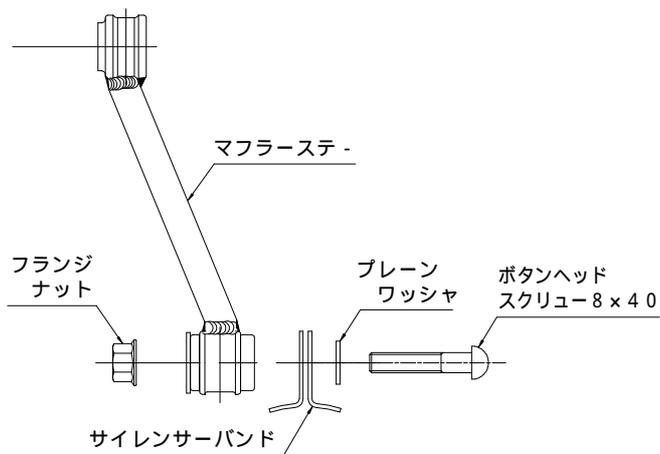
エキゾーストパイプフランジSTDナットを規定トルクで締め付ける。
