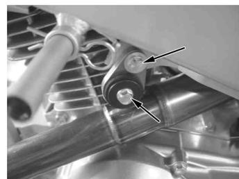
サイレンサーCOMP.ステー部のボルトを規定トルクまで締め付けます。
