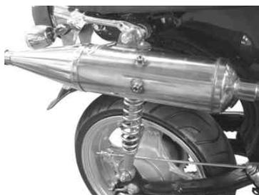
4. エキゾーストパイプCOMP.を、サイレンサーASSY.のジョイント部に差し込んでから、フランジ部をエンジンに差し込みます。
