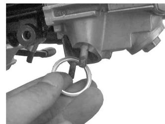
2. 右側リアショックの上部にピボットナットを取り付けます。
