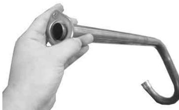
6. 調整した位置がずれないように注意しながら、先にエキゾーストパイプフランジナットを、均等に規定トルクまで締め付けます。
