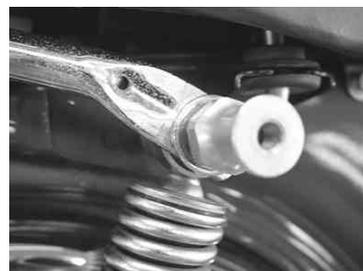
3. サイレンサーASSY.をキット付属のフランジボルトを用いて仮付けします。
