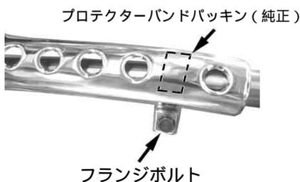
9. マフラーガードと、マフラー本体やフレームとの干渉が無いか確認します。必要に応じて、各部スクリュー・ナットを緩め、マフラーに無理のかからない範囲で、位置を調整し固定して下さい。
