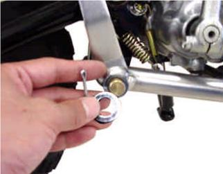
リヤブレーキ-ム、ピボット部の割ヒンをブライヤ-等で取り外し、ワッシャ-を取り外します。
