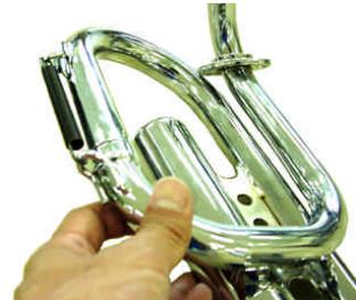
エキゾ-ストパイプをマフラー-COMPに差込みエキゾ-ストパイプスプリングフック部及びマフラー-COMPスプリングフック部にジョイントスプリングをスプリングフック等の工具で取り付けます。
