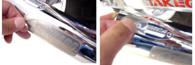
マフラー-に貼り付けてあるネ-ムプレート及びJMCAプレートの保護フィルムを剥がします。
