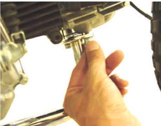
エキゾ-ストパイプをシリンダ-ヘッドEXボ-ト部に差込み、STDナットを用いて仮締めします。
