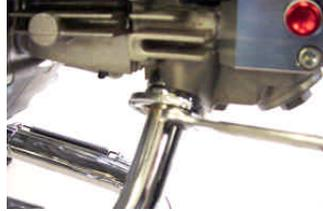
シリンダ-ヘッドEXボ-ト部のSTDナットを均等に規定トルクまで締め付けます。
