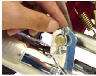
リヤブレーキ-ムピボットシャフトの穴にKIT内のスプリングピンを取り付けマフラー-COMPを固定します。
