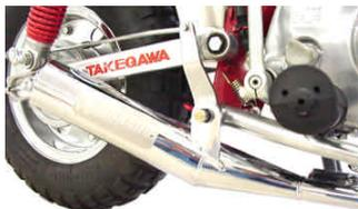
マフラー-COMPステ-部をリヤブレーキ-ムピボットシャフトに取り付けます。
