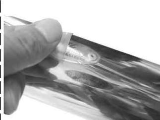
マフラーに貼り付けてあるJMC Aプレートの保護フィルムを剥がします。
