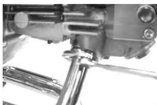
シリンダーヘッドEXポート部のSTDナットを均等に規定トルクまで締め付けます。
