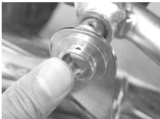
マフラーCOMP のステー部にキット内のストッパーカラーを差し込み、フレームのリア ブレーキアームピボットシャフトに取り付けます。
