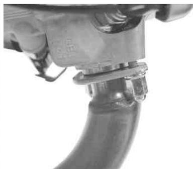
5. マフラーCOMP のサイレンサー部にクランプバンドを差し込み、マフラスターにフランジボルト M8 × 20 及びフランジナットを用いて取り付け、仮締めします。
