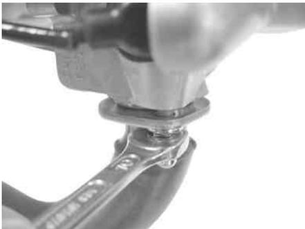
8. ピボットナット部のフランジボルトを規定トルクまで締め付けます。
