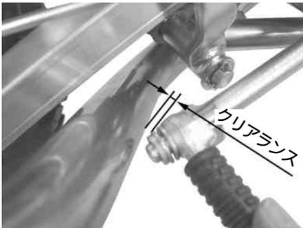
車両の個体差により調整を行っても干渉する場合があります。弊社製キックスターターアームへの交換を行って下さい。
