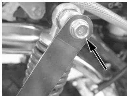
4. マフラーCOMP をシリンダーヘッドエキゾースト側に差し込み STD ナットを用いて仮締めします。
