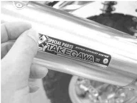
12. エンジンを始動させ、排気漏れの有無を確認します。
