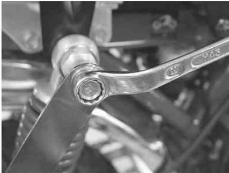
9. クランプバンド部のフランジボルトを規定トルクまで締め付けます。
