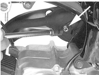
4. エキゾーストパイプフランジ部のナット2個を取り外します。
