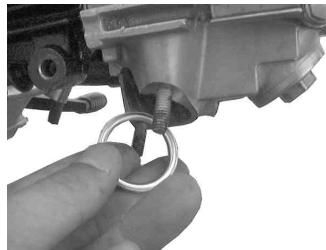
2. サイレンサーASSY.を車両に仮付けします。サイレンサーのパイプ後端を、右リアショック上部の後ろを通して、フランジボルトをサイレンサーステーに通し、裏側にカラーを通して、フレームに仮止めします。
