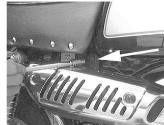
6. エキゾーストフランジのカラー2個を取り外し、外側に引くようにして、マフラーを車体から取り外します。
