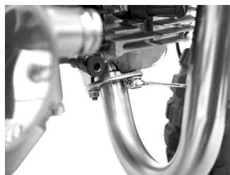
7. 次にサイレンサーステー部のフランジボルトを規定トルクまで締め付けます。
