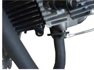
シリンダーヘッドEXポート部のSTDナットを均等に規定トルクまで締め付けます。
