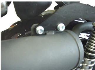
マフラーCOMP. のステー部と取り付けたマフラスターをフランジキャップスクリューとフランジナットを用いて仮締めします。
