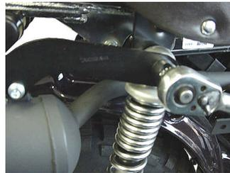
マフラスター部右リアショック上部のピボットナットを規定トルクまで締め付けます。
