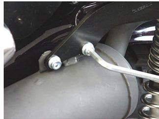
サイレンサー部のボルトを規定トルクまで締め付けます。
