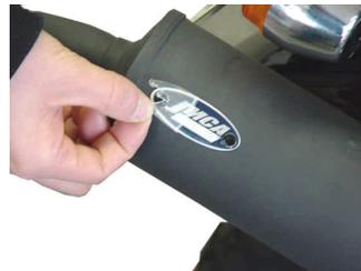
マフラーサイレンサー部のJMAプレートの保護フィルムを剥がします。
