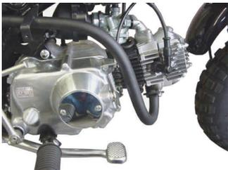
エキゾーストパイプCOMP. をシリンダーヘッドEXポート部に差し込み、STDナットを用いて仮締めします。
