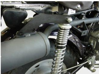
差込部分に耐熱ガスケットの塗布をお勧めします。
