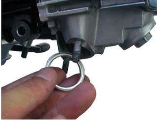
新品のエキゾーストパイプガスケットをEXポート部に差し込み取り付け。
