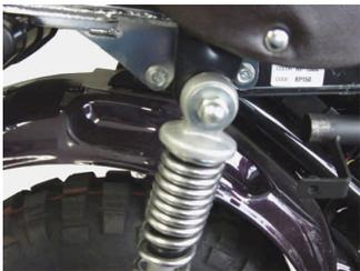
右側リアショック上部のナットを取り外し、マフラスターをSTDナットを用いて仮締めします。
