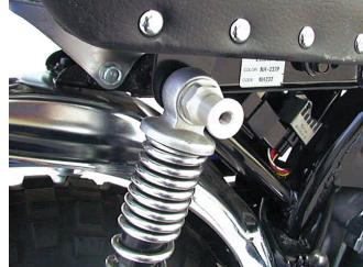
右側リヤショック上部のナットを取り外し、KIT内のピボットナットを取り付け、規定トルクまで締め付けます。
