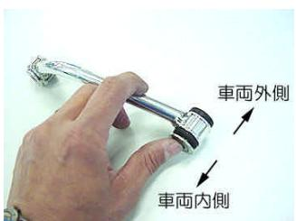
取り付けたマウンティングラバー部にマウンティングカラーを差し込みます。
