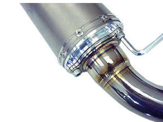
サイレンサーCOMP.をマフラーパイプにソケットキャップスクリューM6×15-3本を用いて取り付け締め付けます。
