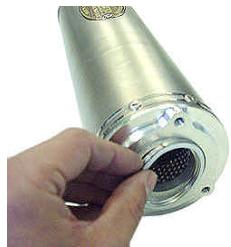
サイレンサーCOMP.の溝部にサイレンサーパイプガスケットを取り付けます。
