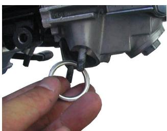
新品のエキゾーストパイプガスケットをEXポート部にさし込み取り付ける。
