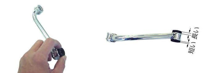
KIT内のマフラーステーにマウンティングラバーを方向に注意し、差し込み取り付けます。
